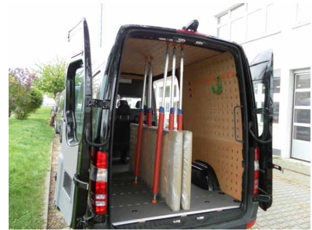
Lochreihen waagrecht in Kombination mit der CargoClips Sperrstange ideal dazu geeignet große schmale Teile wie Türen, Fenster, Platten... sicher zu transportieren. Links und rechts freier Zugang zu Material und Werkzeugregalen
