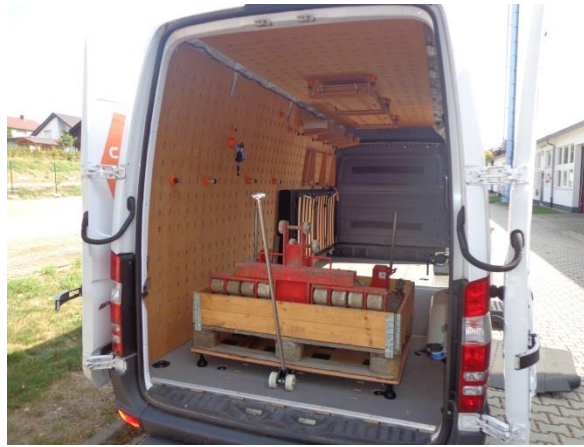
Die Lenk- und Hebestange wird angesetzt
