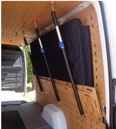
Bretter und Matratzen können mit Hilfe der Sperrstangen platzsparend an der Fahrzeugwand verstaut werden
