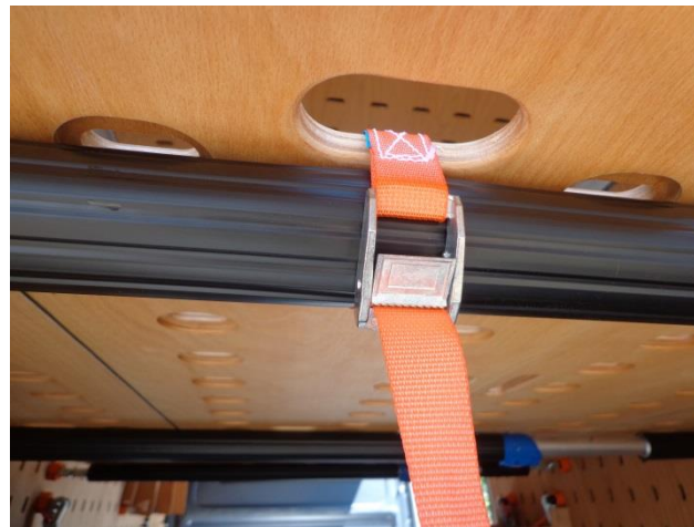
Mit den mitgelieferten Spannriemen werden die Bretter gegen verrutschen und kippen gesichert
