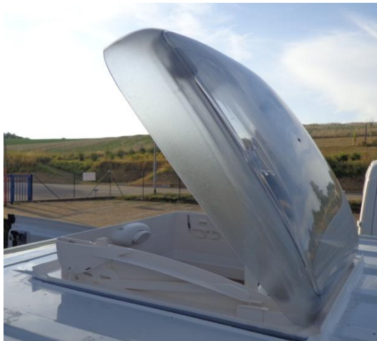
Aerodynamisch geformte Glaskuppel, vollständig geöffnet
