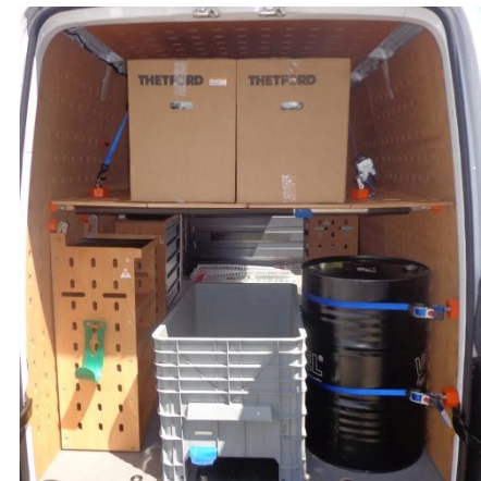
Mit der Gurtbox können Transportgut und Boxen auf dem Klappregal und Doppeltem Boden zusätzlich gegen das Verrutschen gesichert werden
